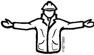
START Arme horizontal ausgestreckt, Handflächen zeigen nach vorne
